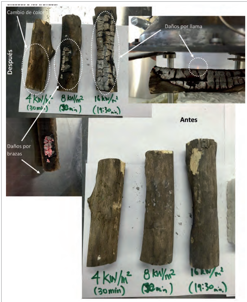
Figura 13. Tres muestras de troncos sometidos a 4 \text{ kW/m}^2 , 8 \text{ kW/m}^2 y 16 \text{ kW/m}^2 . El tronco calentado a 4 \text{ kW/m}^2 muestra los primeros indicios de degradación. Se puede observar el oscurecimiento del tronco pero no hay indicios de combustión. A 8 \text{ kW/m}^2 la combustión se inicia generando brazas pero no llama. A 16 \text{ kW/m}^2 se enciende una llama y se observa un consumo importante del tronco. Ensayos ejecutados el 20 y 21 de Julio del 2015.
