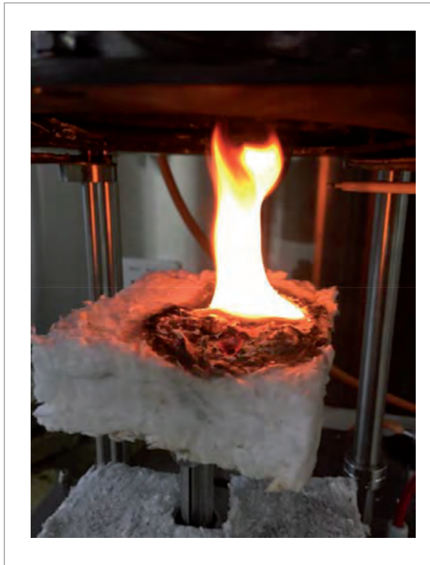
Figura 15. Envase mostrado en la Figura 12 después de 30 segundos de exposición a 16 \text{ kW/m}^2 (21 de julio, 2015).
