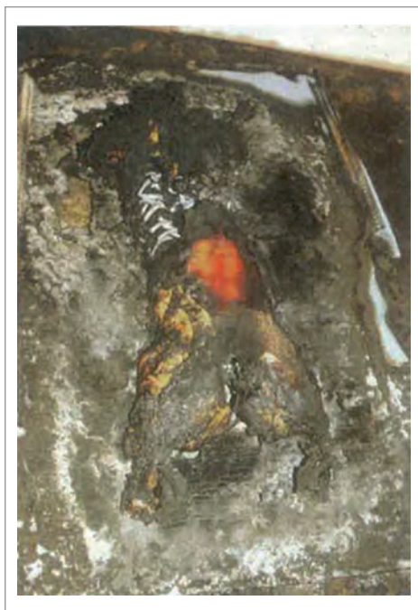
Figura 6. Residuos de la cremación de un cerdo (deHaan y Icove, 2012). Cuando el cuerpo se incinera en función a sus propias grasas deja, después de más de 6 horas de quemado, aproximadamente el 50% de su masa como residuo.
